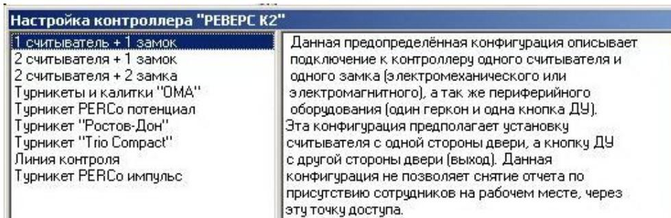
Выбрав подходящую вам конфигурацию, нажмите «Готово», перед вами откроется окно свойств «Реверс-К2». Здесь нужно ввести производственный адрес контроллера К2. Адрес указан на плате контроллера, в паспорте и на коробке. Вы можете присвоить название контроллеру, затем нажмите «ОК» для закрытия окна.
