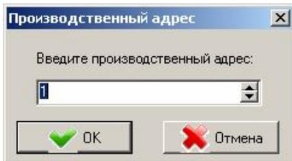
В открывшемся окне нужно ввести производственный адрес контроллера «Реверс-СК2». Адрес указан на плате контроллера, в паспорте и на коробке.
