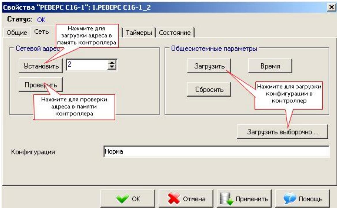
Если полученный адрес совпадает с установленным, можно загружать конфигурацию в контроллер, для этого нажмите кнопку «Загрузить выборочно».
